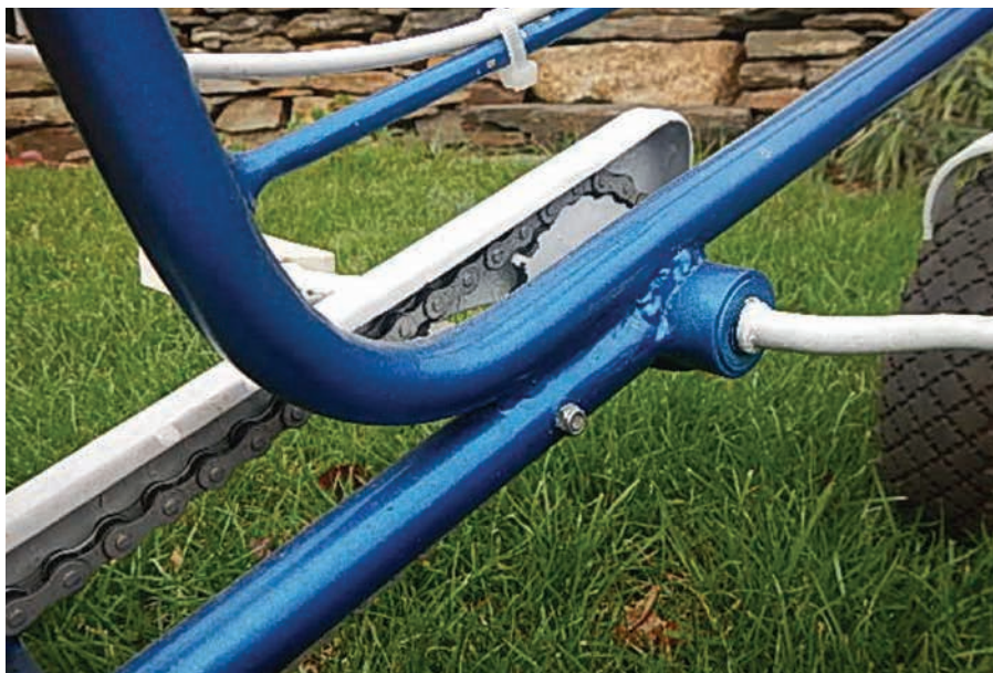
b) Detail středového uložení šlapadel
