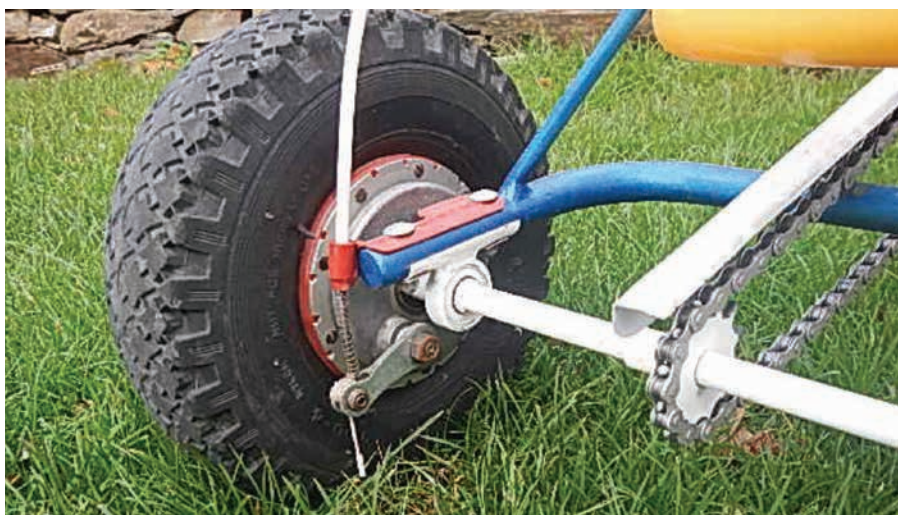
c) Detail brzděného kola
